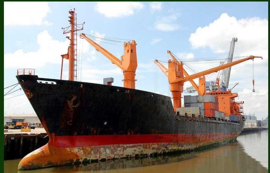
Vodni trag - trošenja premaza uslijed obraštanja i koroziije (Foto: Paul Brennan / Pixabay)
